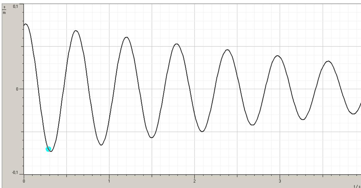
**Abb.2a:**  $s(t)$ -Kurve Federpendel
