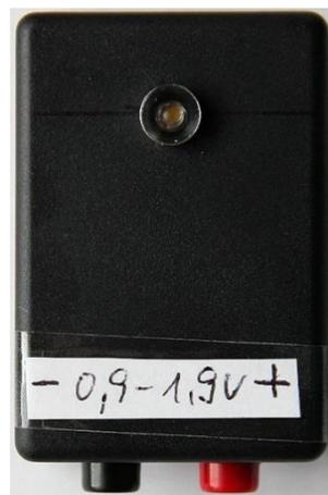
**Abb.3: LED-Anzeigelampe 2 ohne zusätzliche Messbuchsen**
