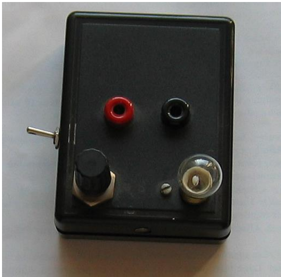
Abb.3: Trübungsanzeiger mit Lampe
