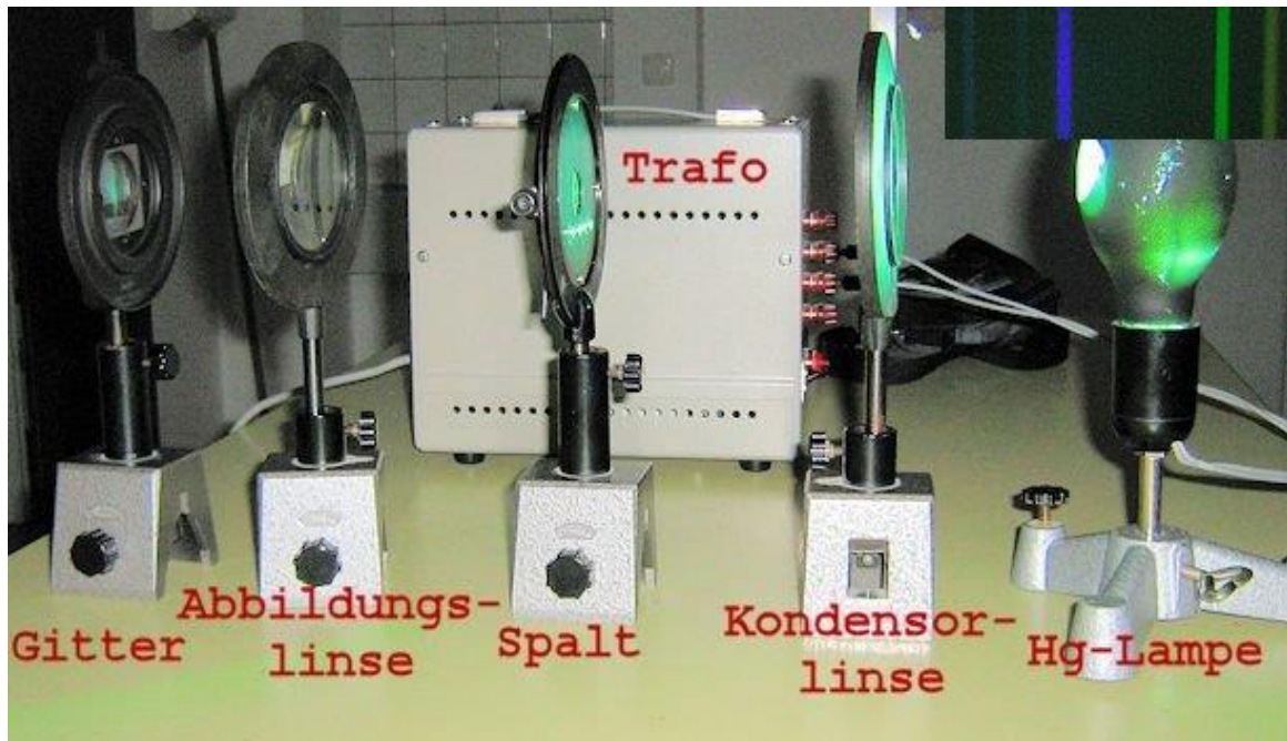
Abb.3: Farbzerlegung mit einem optischen Gitter
