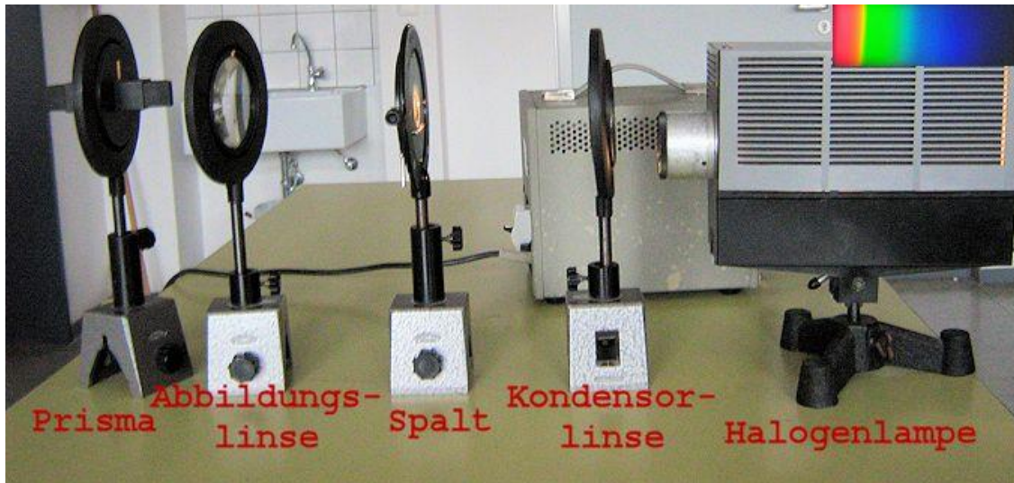
Abb.3: Farbzerlegung mit einem Prisma
