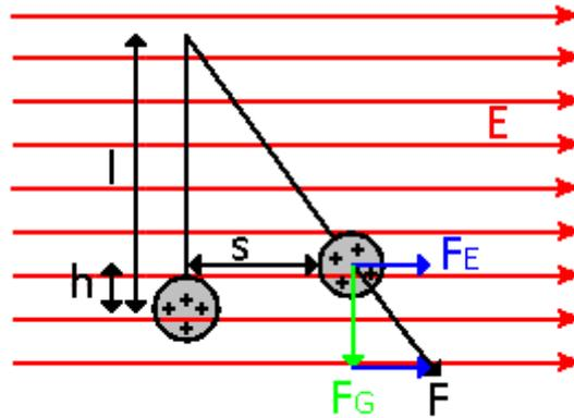
**Abb.5: Auslenkung einer Kugel im elektrischen Feld**
