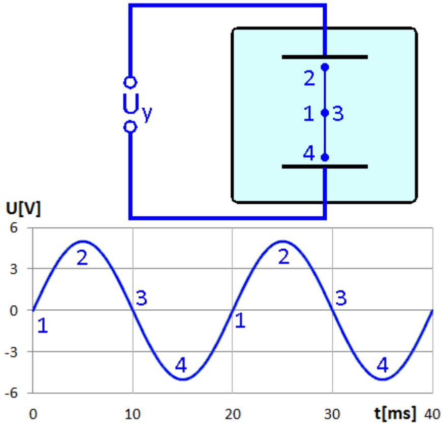
Abb.1: Sinusspannung am y-Plattenpaar
