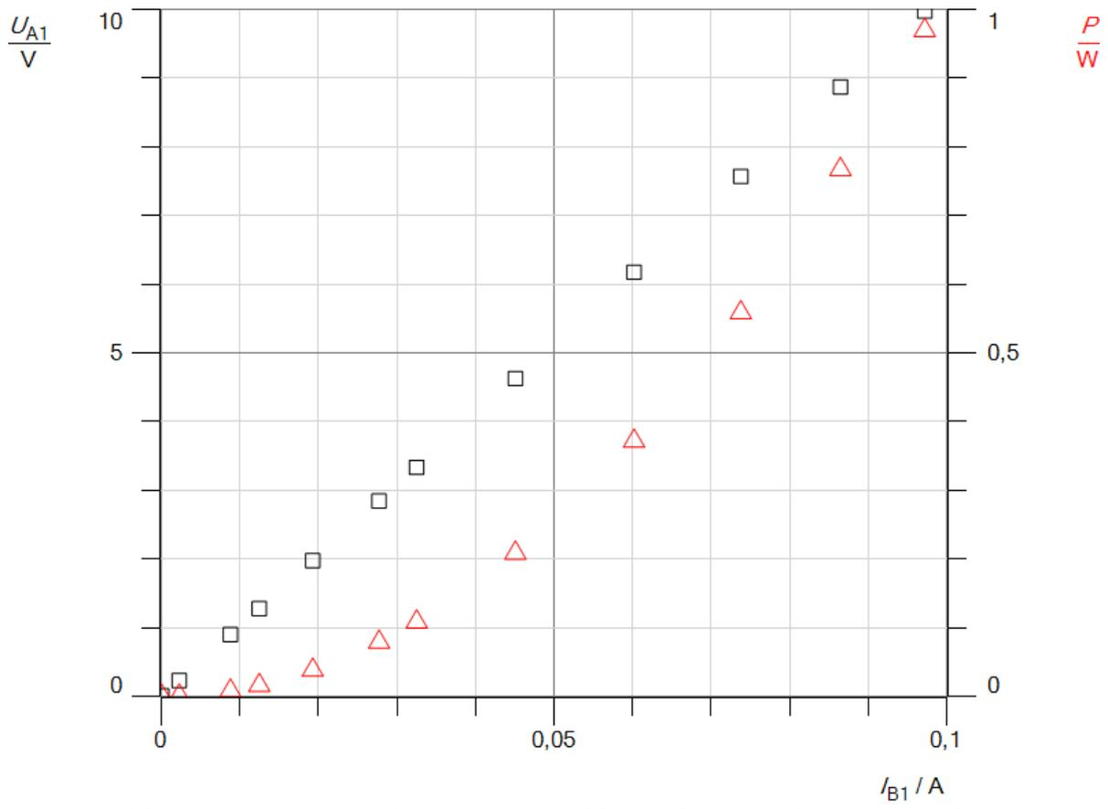
**Abb.2: Spannung U und Leistung P in Abhängigkeit von der Stromstärke I**
