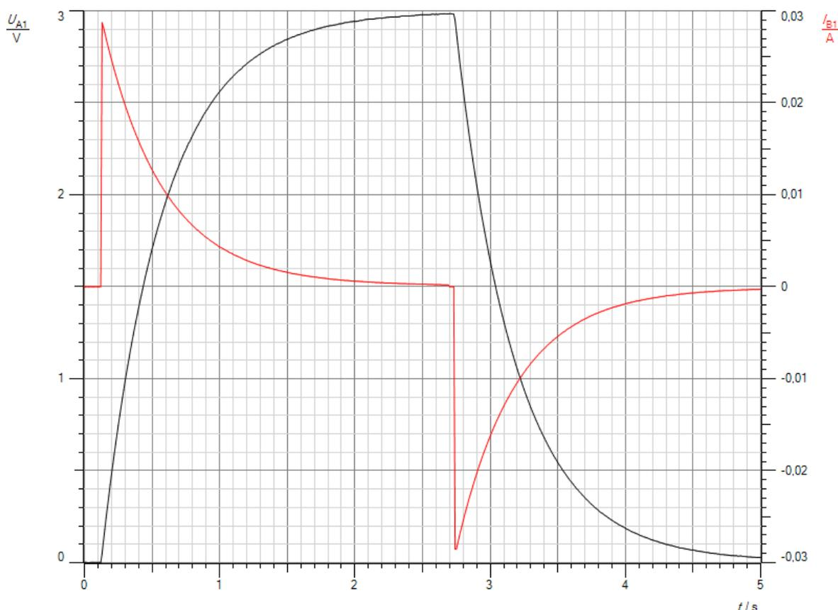
**Abb. 3: Lade und Entladekurve eines Kondensators**
