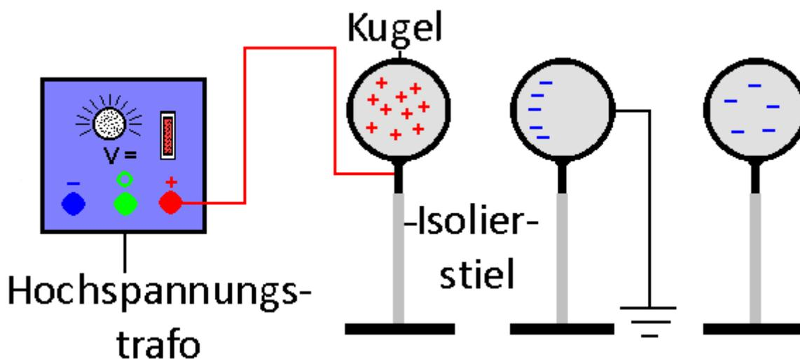
Abb. 4: Dauerhafte Ladung einer Kugel durch Influenz
