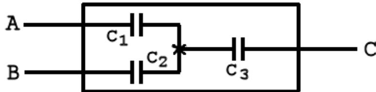
Abb.2: Schaltplan der drei Kondensatoren
