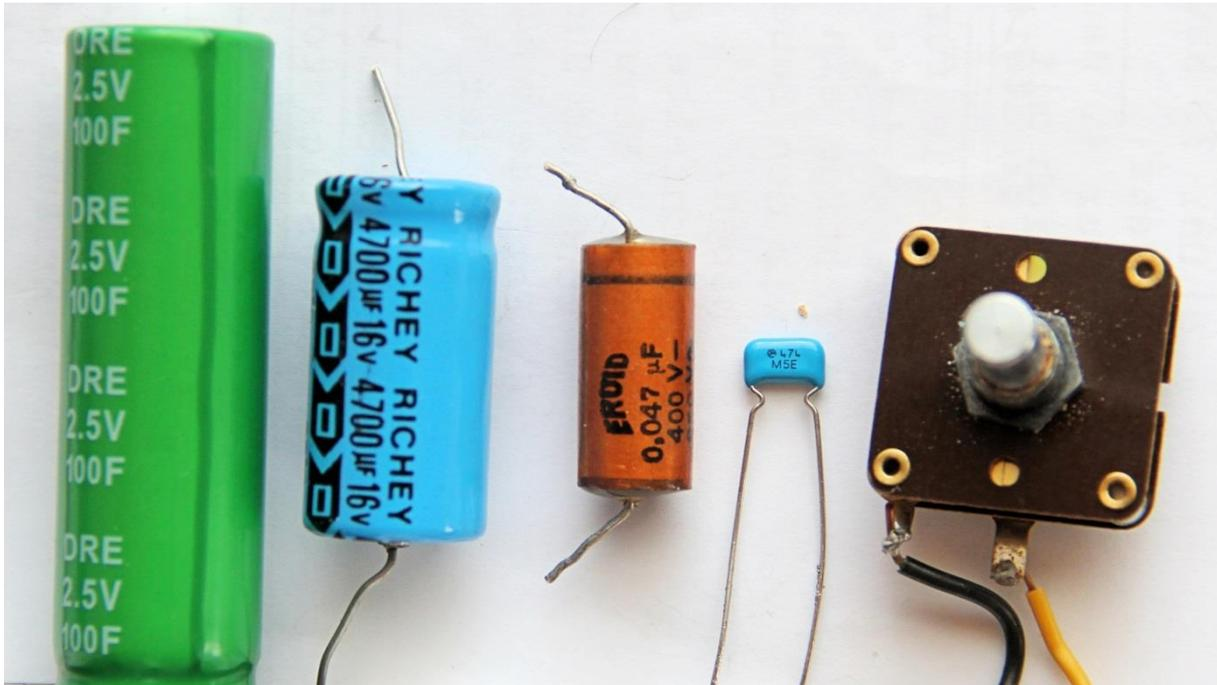
**Abb.1 (v. l. n. r.): Doppelschicht-, Elektrolyt-, Folien-, Keramik-, Drehkondensator**
