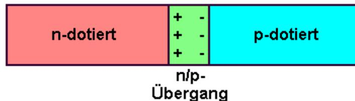
**Abb.1: Aufbau einer Diode**
