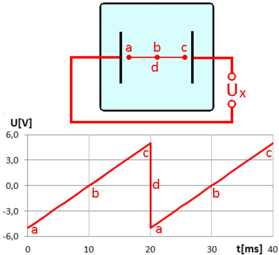
Abb.2: Verlauf der Sägezahnspannung an der Zeitachse
