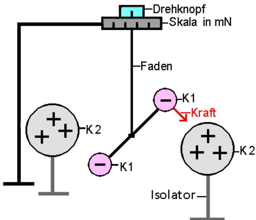
Abb. 5: Torsionsdrehwaage
