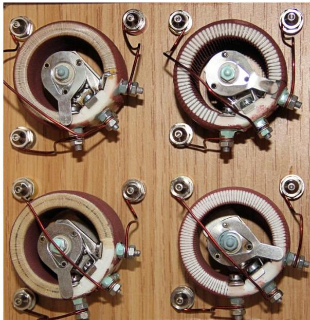
**Abb.1b: Drehpotentiometer hoher Leistung**
