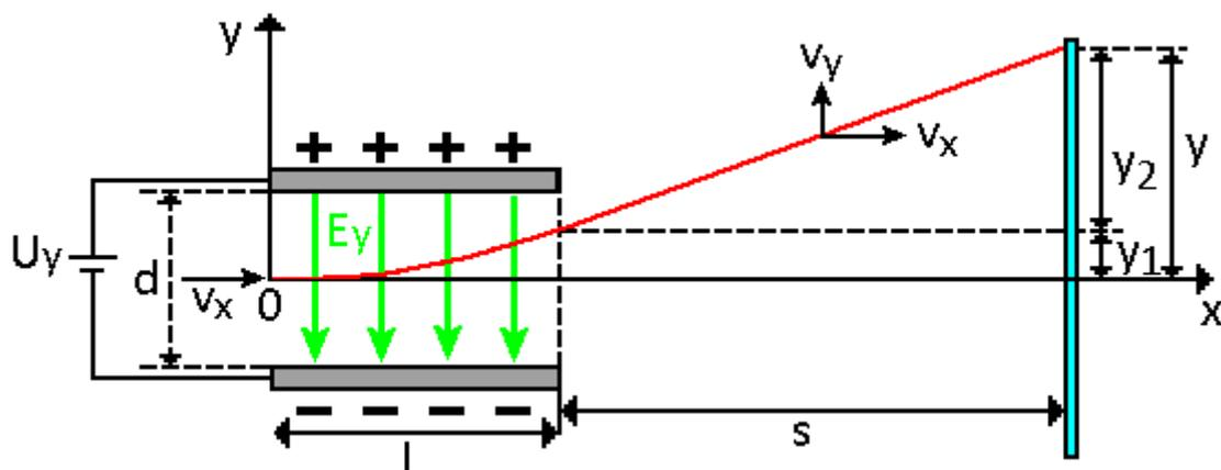
Abb.1: Ablenkung von Elektronen im elektrischen Feld
