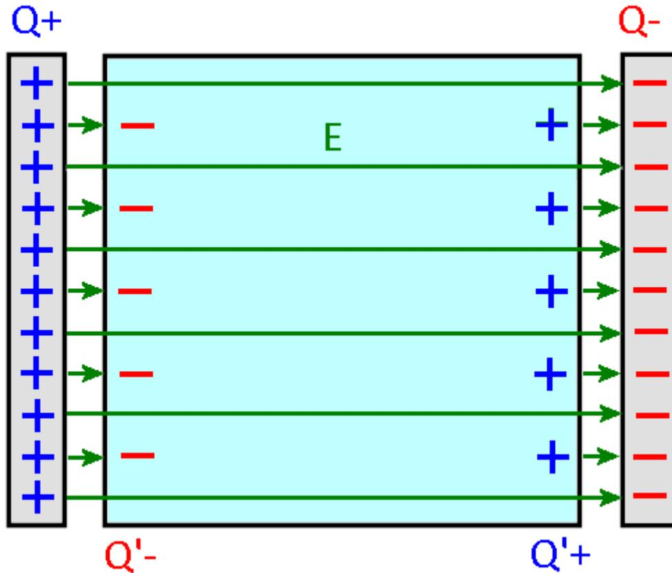
Abb.2: Schwächung des elektrischen Feldes durch einen Isolator
