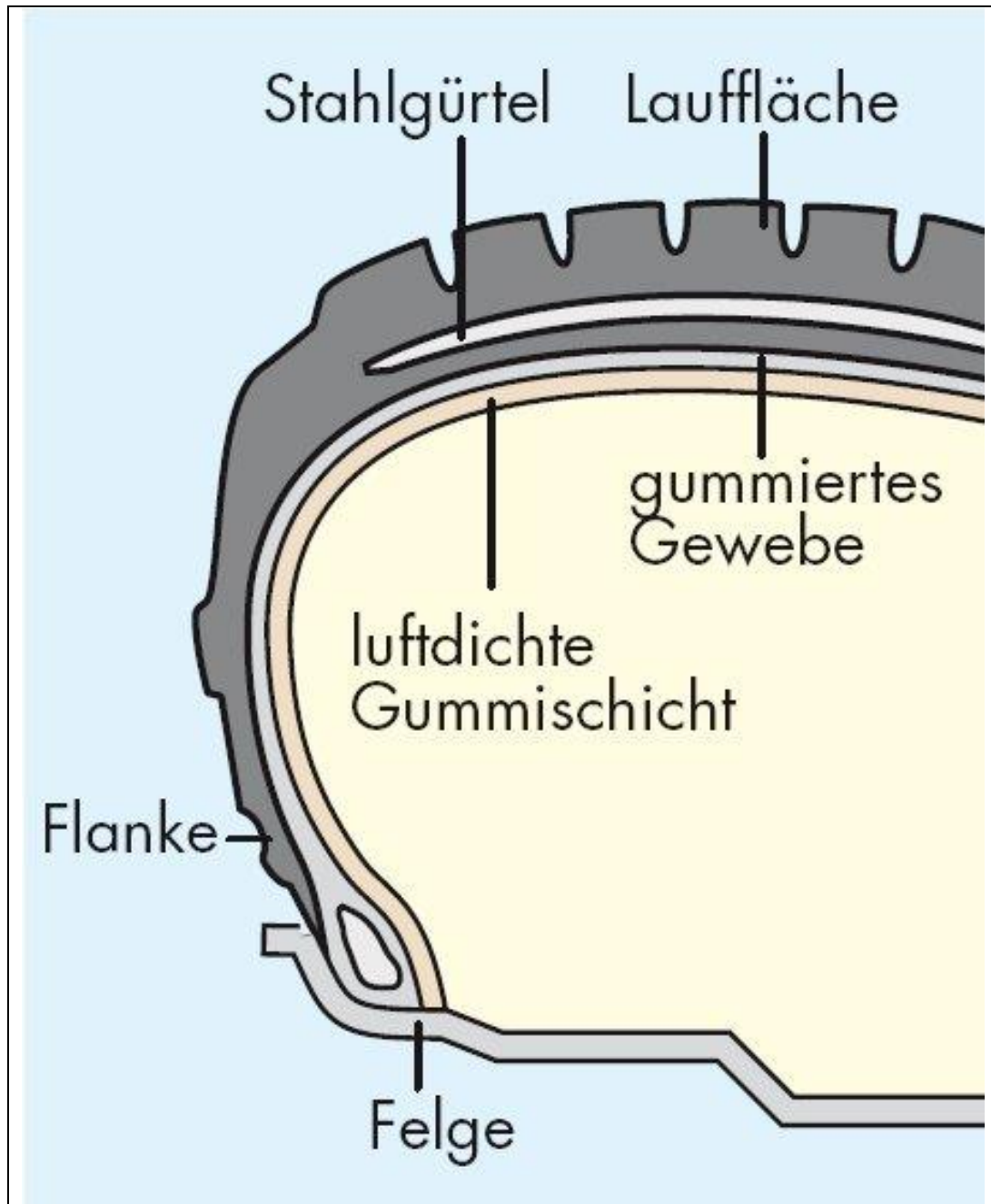
Abb.1: Aufbau eines Autoreifens
