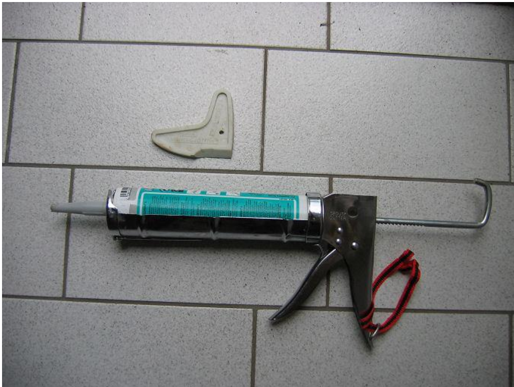
Abb.1: Werkzeuge zur Herstellung einer Siliconfuge
