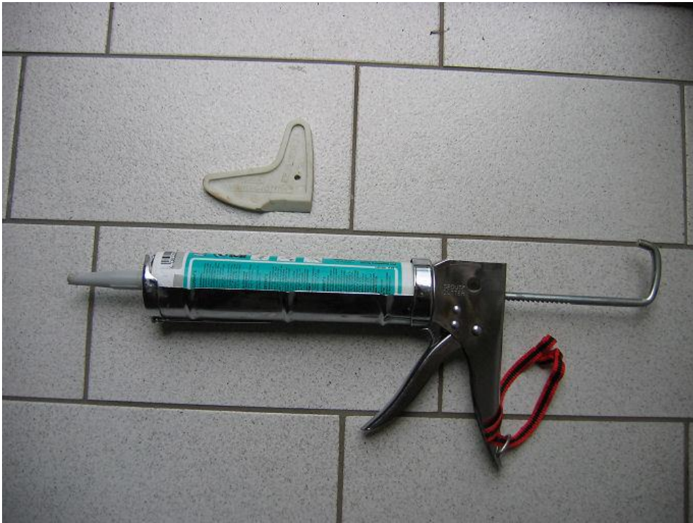
Abb.1: Werkzeuge zur Herstellung einer Siliconfuge
